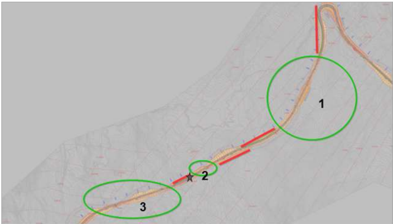
Figur 7-11 Områder uten rekkverk og fjellskjæring i planforslaget er markert med grønn sirkel. Røde linjer indikerer områder med rekkverk eller fjellskjæring. Område 1 er en strekning på ca. 350 m, område 2 er på ca. 100 m, og område 3 er på ca. 360 m. Bom er markert med stjerne.
